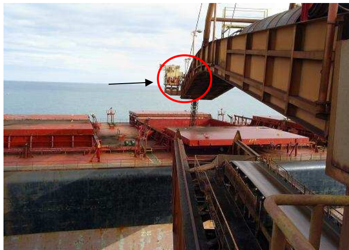
Figura 5.5 : Cabine do operador
