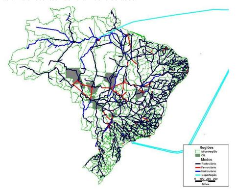
Nota: A figura destaca algumas regiões candidatas à instalação de CILs a fim de demonstrar a possibilidade de transferência modal nestas áreas, conforme será abordado na Seção 5.5
