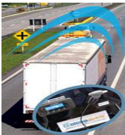
Figura 21 - Sensor de alcoolemia integrado a rastreador de veículos
