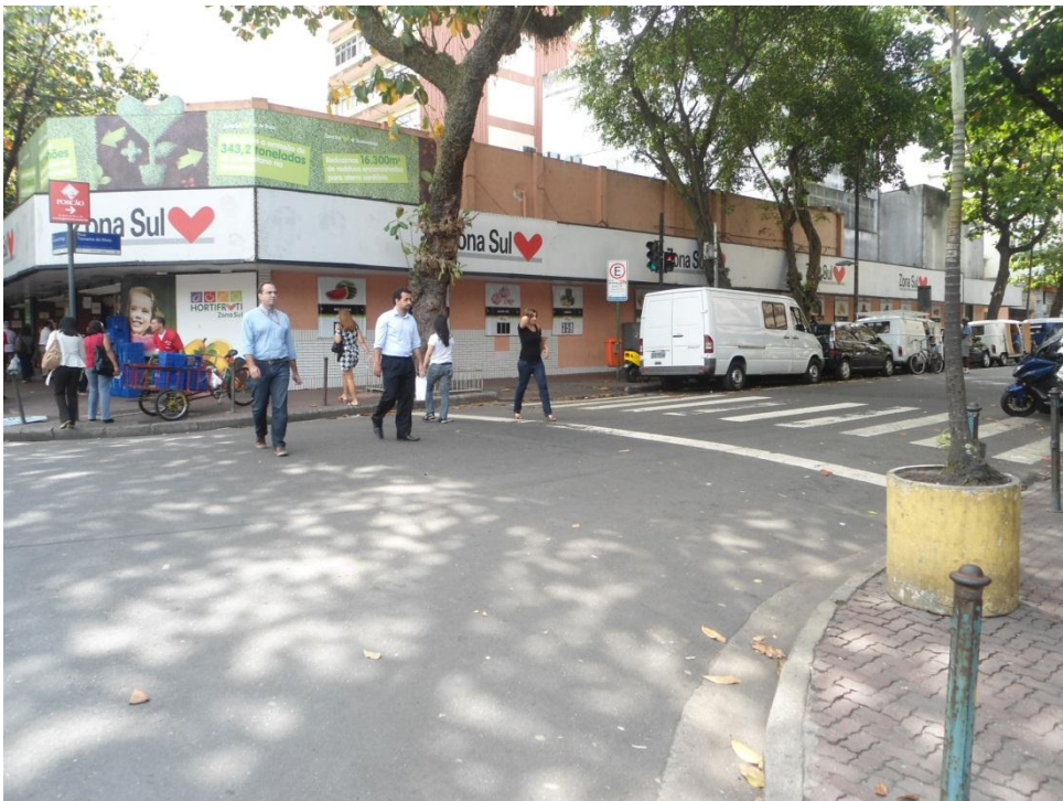
Foto A-6: R. Teixeira de Mello com R. Visc. de Pirajá → travessia de pedestres afastada da interseção levando os pedestres a atravessar fora da faixa.
