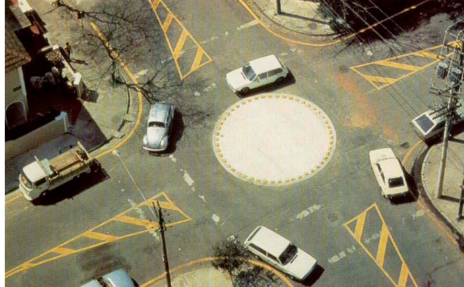
Figura 4.12: Rotatória contornada por tachões e ilhas de deflexão em pintura.
