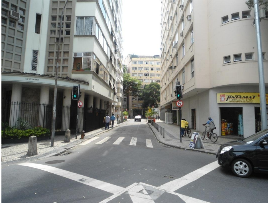
Foto A-1: Entrada da Zona 30 pela R. Piragibe frota Aguiar → Não há qualquer sinalização para indicar os motoristas que está entrando numa zona com restrição de velocidade, de modo a buscar rotas alternativas.
