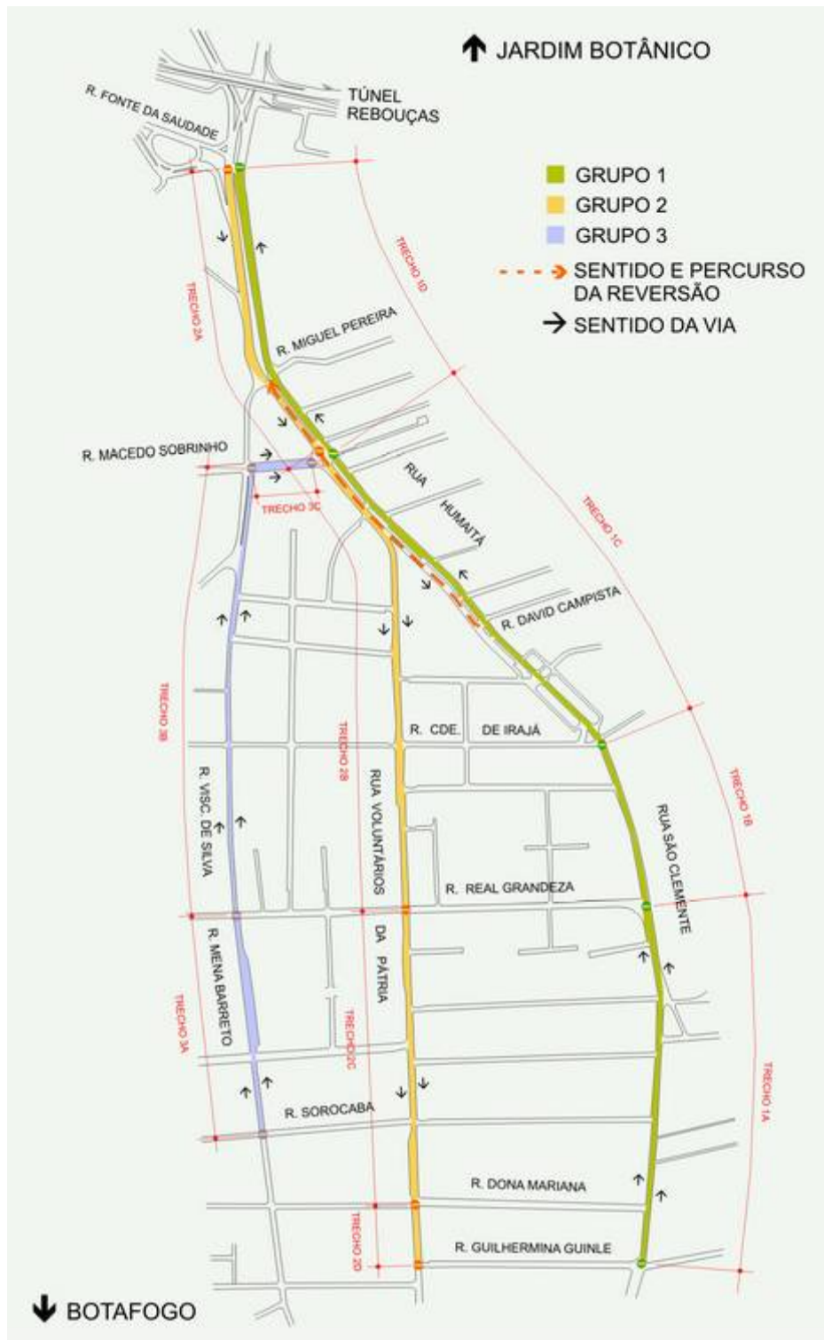
Figura 22: Panorama geral dos trechos de levantamento de tempo de viagem realizada pela CET Rio para faixa reversível da Rua do Humaitá.
