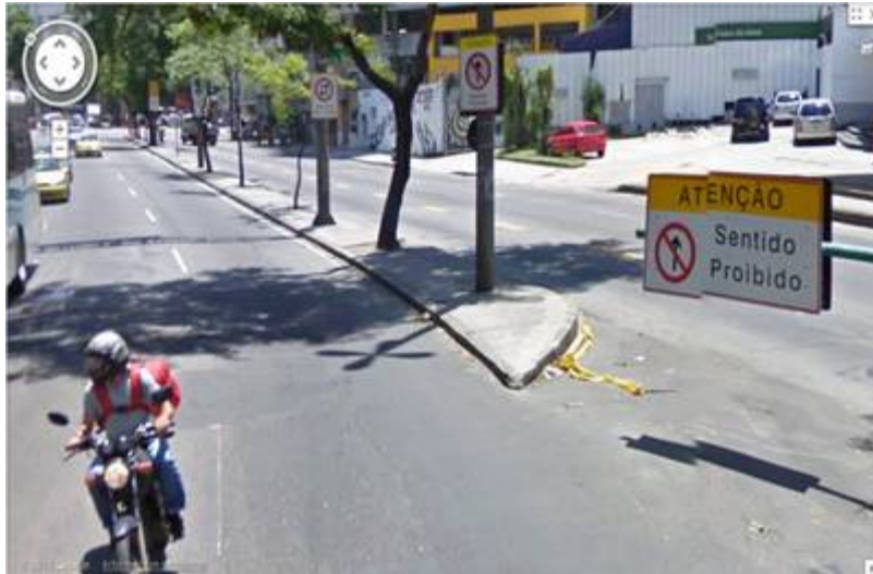
Figura 21: Sinalização e cancela como dispositivo de controle na faixa reversível da Rua Humaitá.
