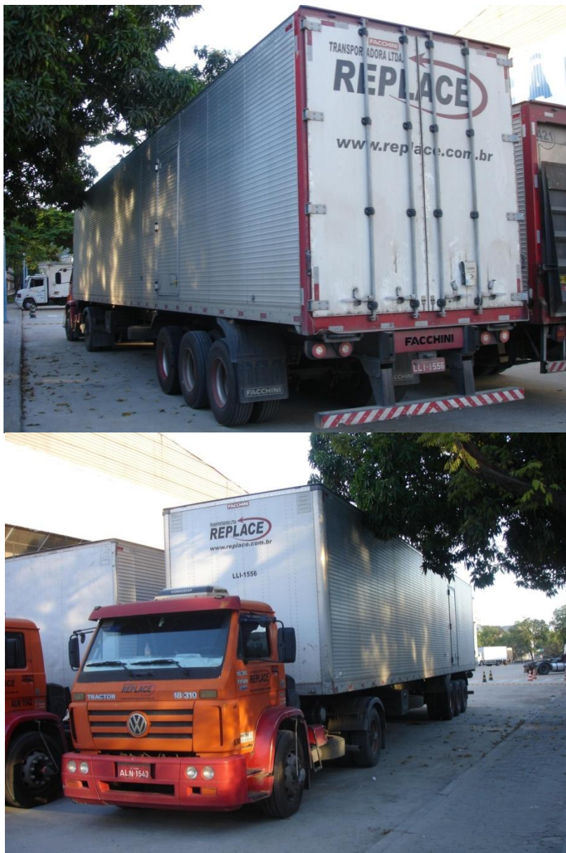
Figura 4: Caminhão e semi reboque (carreta) pesado, 5 eixos, capacidade de carga 27 toneladas.
