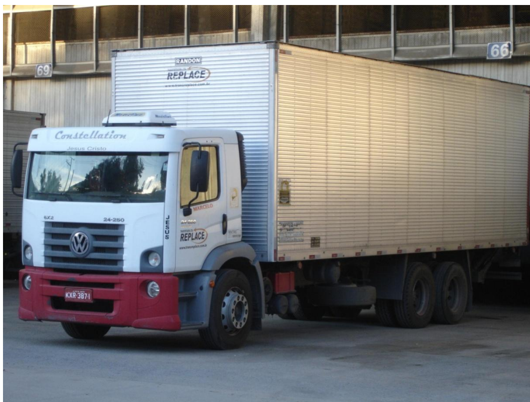
Figura 3: Caminhão 6x2 (Truque), médio capacidade de carga 14 toneladas.
