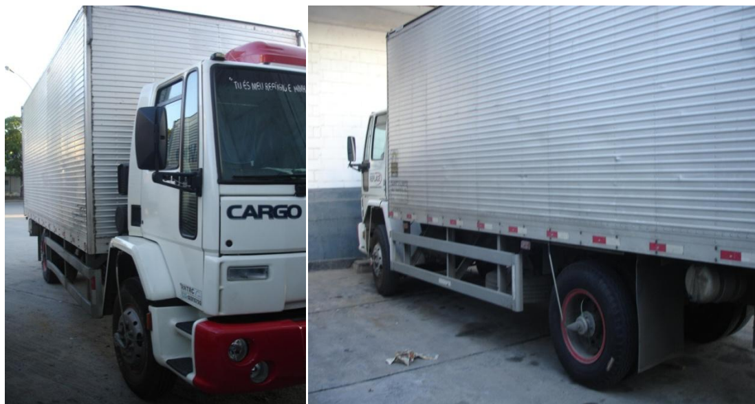
Figura 2: Caminhão 4x2 (toco), leve capacidade até 7 toneladas de carga.
