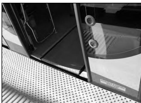
Figura 3.6: Tecnologia de Precisão de Embarque Óptica (WRIGHT e HOOK, 2007)
