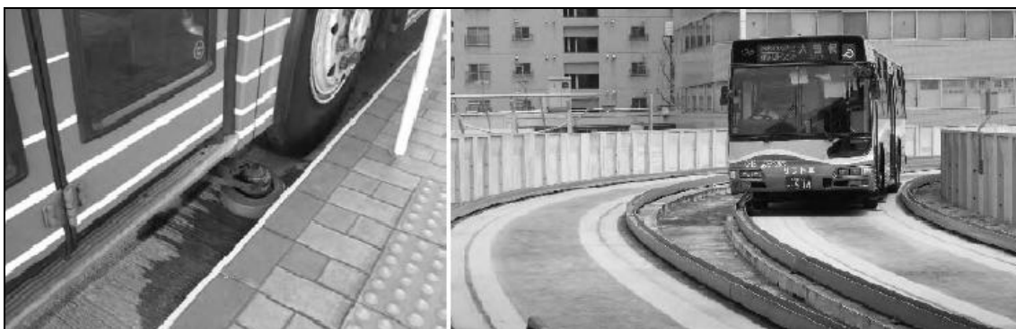
Figura 3.7: Guia Mecânica Utilizada pelo BRT de Nagoya (HOOK e WRIGHT, 2007)
