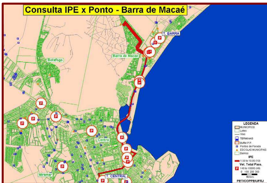
Figura 64 – Etapa de processamento da Análise Preliminar com identificação de duas linhas de maior IPE em contato com Pontos de Parada de maior volume de passageiros.
