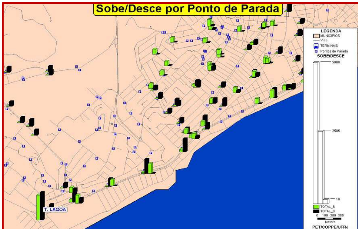
Figura 19 – Mapa parcial de sobe/desce total de passageiros por Ponto de Parada no horário de pico da manhã do Sistema Integrado de Macaé, com volume de embarques na cor verde e volume de desembarque na cor preta.
