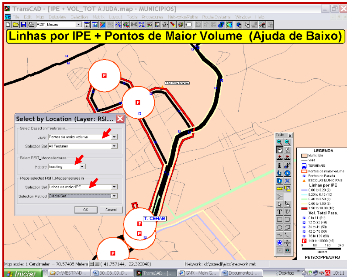
Figura 24 – Exemplo de Análise Preliminar do método proposto, com a identificação de locais onde há ocorrência linhas de maior IPE (linhas em cor vermelha) em contato com pontos de parada de maior volume (pontos em cor vermelha). Este exemplo aborda a utilização do software Transcad através da ferramenta Select by Location .
