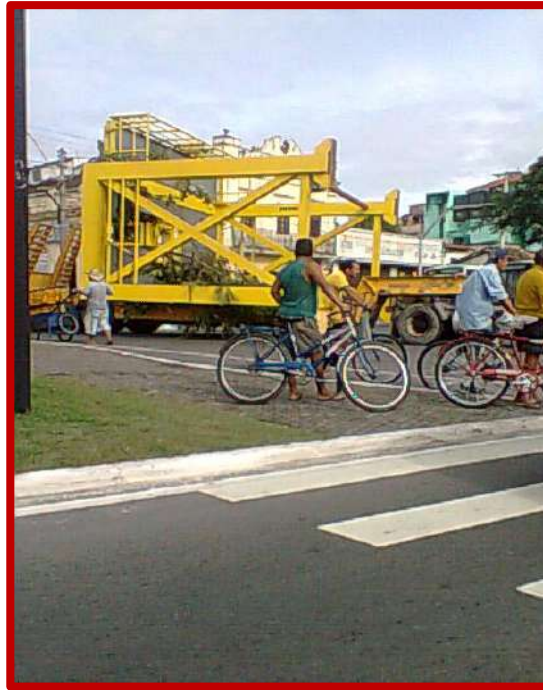
Figura 42 - Estrutura metálica excedente no transporte realizado por carreta, os semáforos tiveram que ser levantados e a ponte Ivan Múndin ficou bloqueada para a passagem do material. Estima-se atualmente um fluxo de 700 carretas/dia em Macaé.
